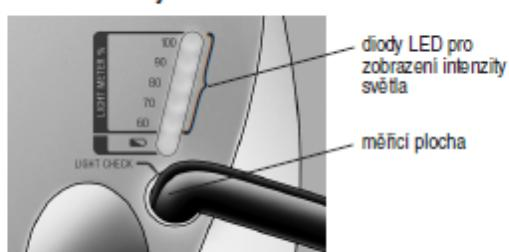
Spolehlivé určení intenzity světla u lampy přístroje Elipar DeepCure-S je možné provést pouze na příslušné nabíječce Elipar DeepCure-S! Kruhová měřící plocha se nachází na nabíječce pod stupnicí pro intenzitu světla. Měření na nabíječce Elipar FreeLight, FreeLight 2 nebo Elipar S10 (předchozí modely k Elipar DeepCure-S) nebo na jiných přístrojích vede kvůli rozdílným zdrojům světla a rozdílnému uspořádání dílů k chybám výsledkům.
